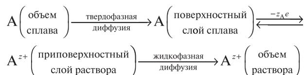
Пространственно-временной концентрационный профиль атомов А в сплаве  $c_A(x; t)$  и ионов в растворе  $c_{A^{z+}}(x; t)$  описывается системой дифференциальных уравнений нестационарного диффузионного массопереноса:
