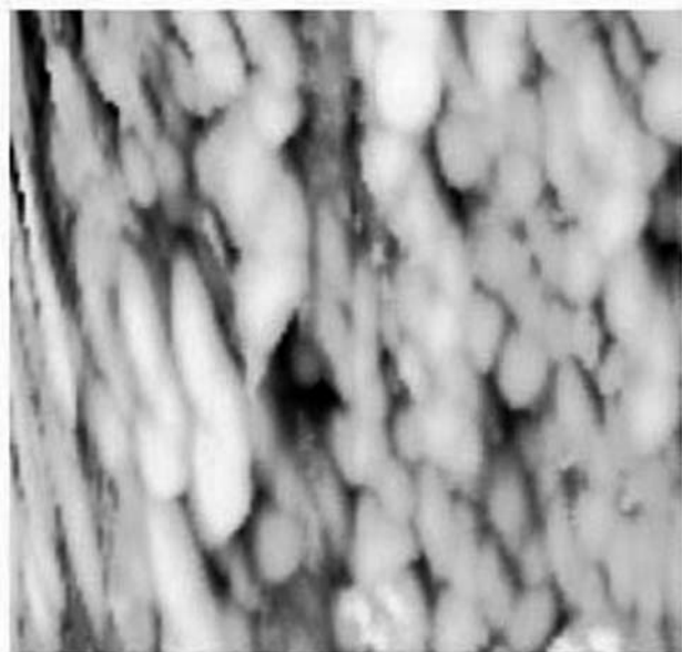
Рис. 1. Результат сканирования рельефа образца «золото на слюде» (размер области сканирования 0,19 \times 0,19 мкм, левый рисунок — вид сверху, правый рисунок — вид сбоку).
